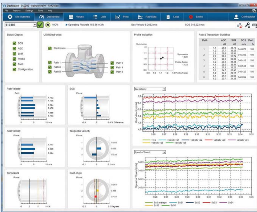
RMGView USM Leistungsüberwachung aller Diagnoseparameter in Echtzeit
