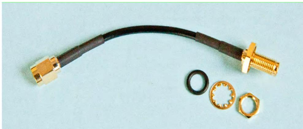
Abb. 40: Kabeladapter für externe Antenne
