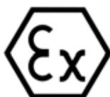
Das Gerät entspricht der Zündschutzart II 2 G Ex de IIB+H2 T6 Gb.
