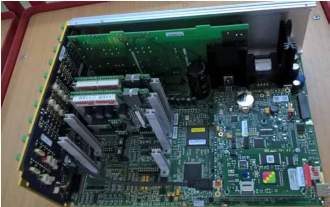
Bild 8-21: Steckplatz der Optionskarte für COM6 und 7 des ERZ 2000-NG
