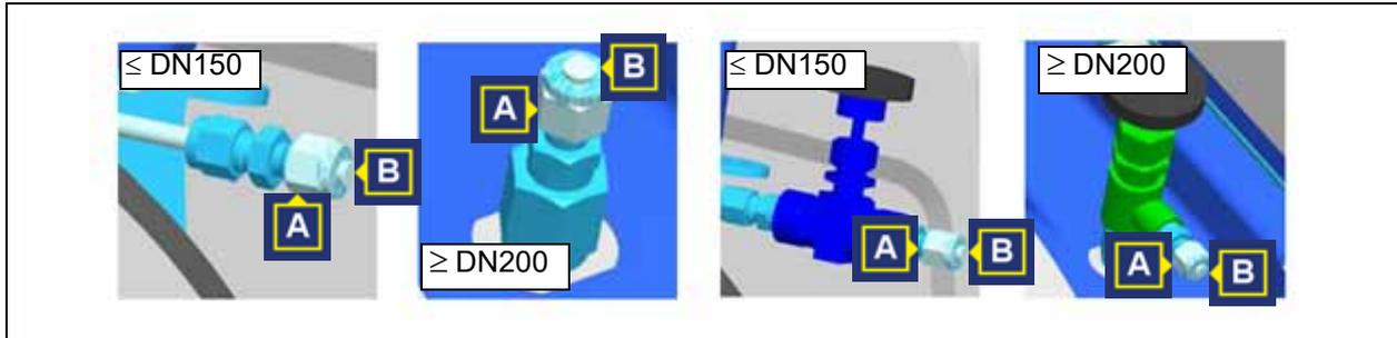
A Überwurfmutter der Klemmringverschraubung  $\varnothing$  6 mm
