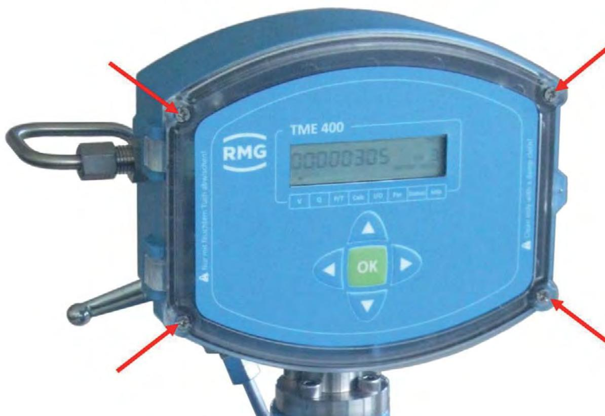
**Abbildung 3: Lösen der Schrauben zum Öffnen des Deckels**
