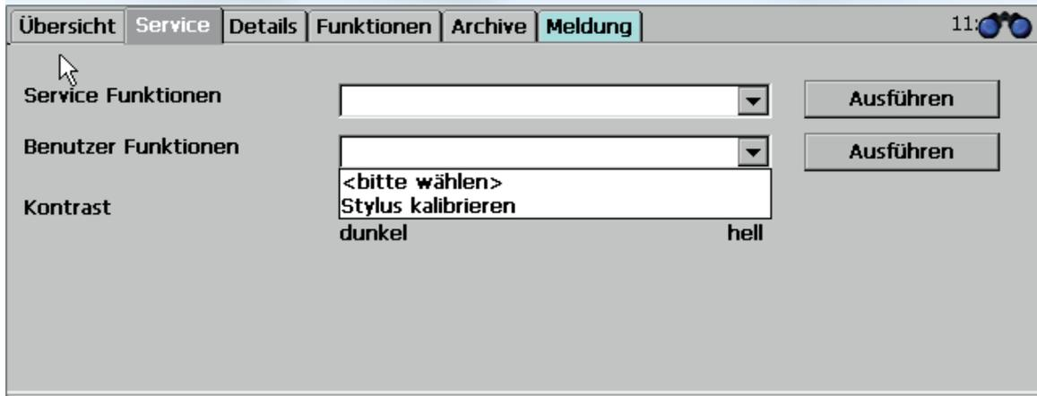
**Abbildung 47: Menü Service / Unterprogramm „Stylus kalibrieren“**
