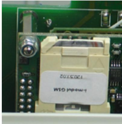
Um den GSM-Modem, bzw. die Empfangsqualität zu überprüfen steht das Dienstprogramm Q im Anzeigemodus zur Verfügung (siehe Seite 9). Vor der Empfangspegelüberprüfung muss die Antenne angeschlossen sein und die Stromversorgung eingeschaltet werden.
