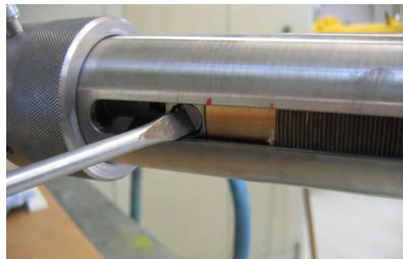
4. Ziehen Sie die Überwurfmutter fest an und sichern Sie diese mit der Fixierschraube.
