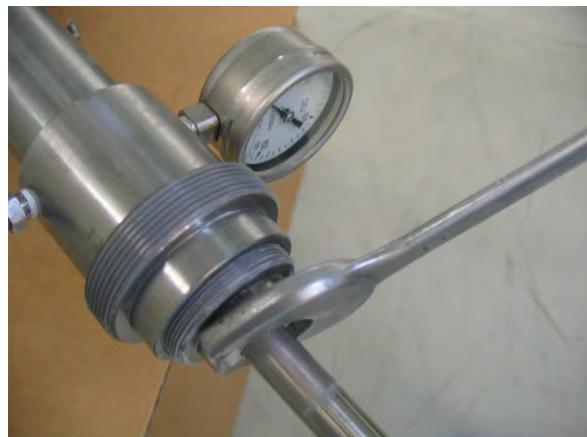
2. Schrauben Sie jetzt mit der Hand die Gewindeeinheit mit der Überwurfmutter an der Druckkammer fest. Achten Sie darauf, dass die Gewindehülse dabei drehbar bleibt (vgl. „Wechselwerkzeug montieren“, Schritt 8).
