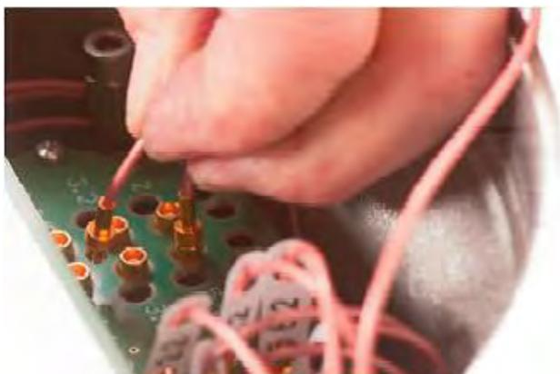
5. Alle Kabel nach oben ziehen und so fixieren (z.B. mit Klebeband), dass sich möglichst wenig Kabel im Innenraum des Gehäuses befinden.
