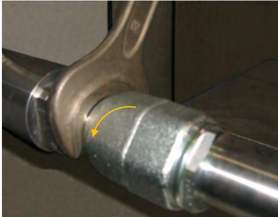
Bei Bedarf Maulschlüssel SW 65 oder Rohrzanze verwenden
