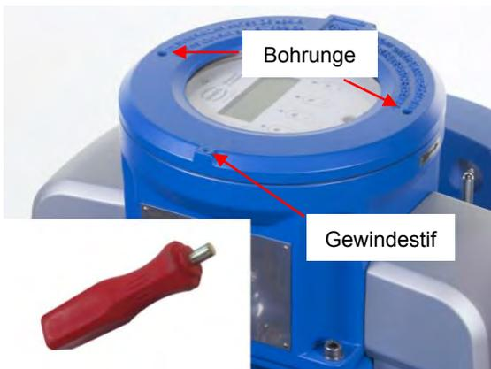
Entfernen sie zunächst den Gewindestift, mit dem der Gehäusedeckel fixiert ist. Im Gehäusedeckel befinden sich zwei Bohrungen zur Aufnahme der Öffnungsgriffe. Stecken Sie die Öffnungsgriffe in die Bohrungen und drehen Sie damit den Gehäusedeckel gegen den Uhrzeigersinn. Legen Sie den Deckel beiseite und achten Sie darauf, dass der Deckel und das Gewinde nicht beschädigt werden, da sonst der Explosionsschutz nicht mehr gewährleistet ist.
