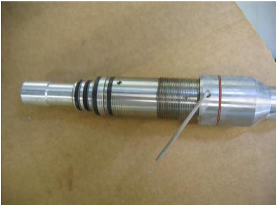
2. Ziehen Sie jetzt den Transducer aus der Hülse der Kupplungsstange heraus.
