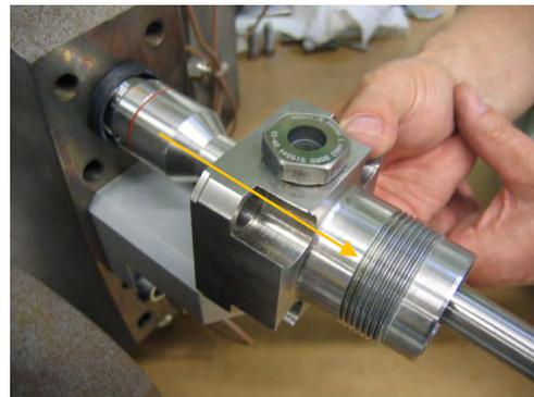
8. Lösen Sie dann die 3 Gewindestifte an der Kupplungsstange und ziehen Sie die Kupplungsstange vom Transducer ab.
