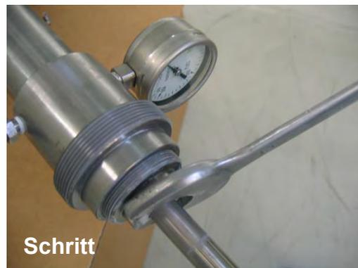
4. Lösen Sie dann die Überwurfmutter komplett und entfernen Sie die Gewindeeinheit.
