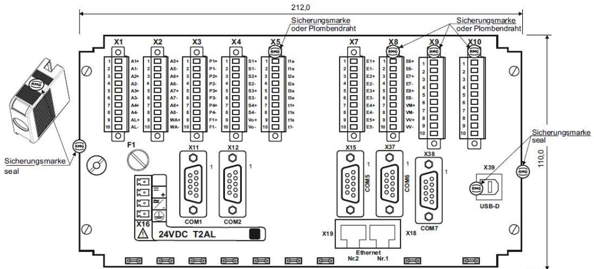
Steckergehäuse mit Sicherungs- oder Plombendraht: Non Ex: X5 und X8
