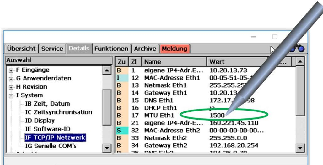
Als Superuser (*Kapitel 2.4 Zugriffsschutz auf Daten und Einstellungen*) können Sie jetzt die maximale Paketgröße des Übermittlungsprotokolls MTU ändern (*Kapitel 2.7 Display-Bildschirm*). Durch Scrollen auf der rechten Seite kommen Sie auch auf die MTU von Eth2, diese ändern Sie bei Bedarf analog.
