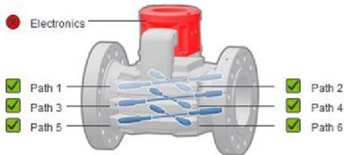
**Abbildung 72: Messpfadanordnung USM-GT400**
