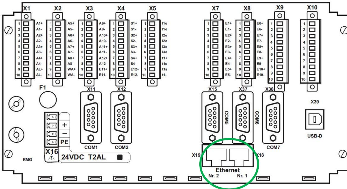
**Abbildung 7: Rückseite des ERZ2000-DI und die Ethernet-Schnittstellen**
