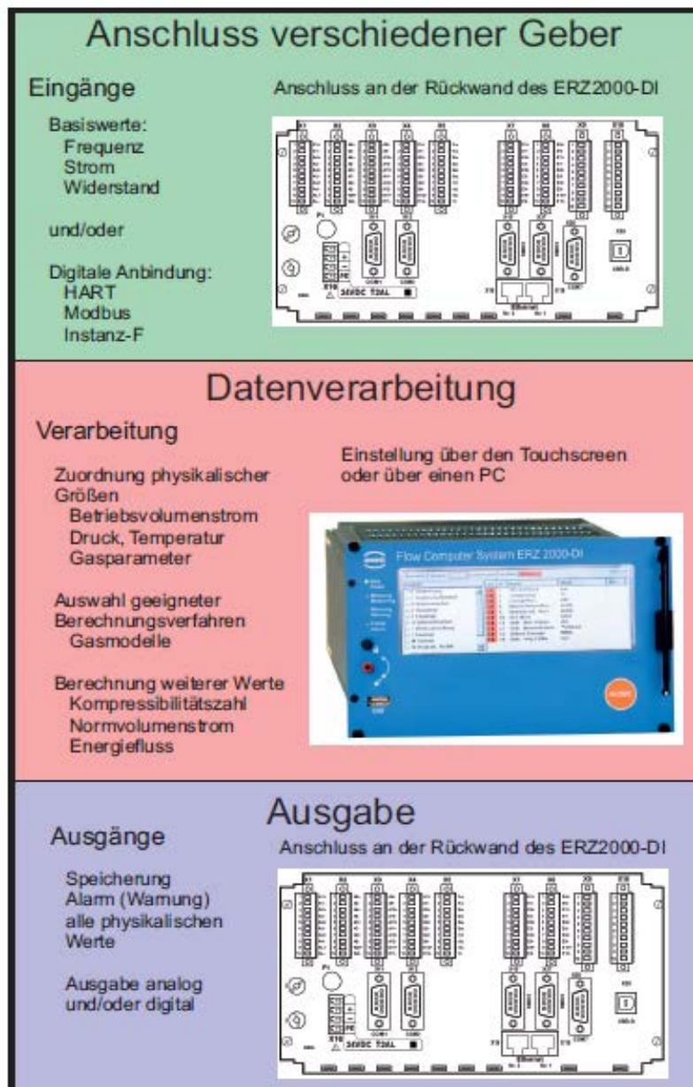
Abbildung 1: Funktionsprinzip
