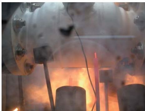
Zdj. Kurek kulowy poddany próbie ogniowej.
