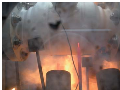
Foto: Kugelhahn nach der Feuerprobe
